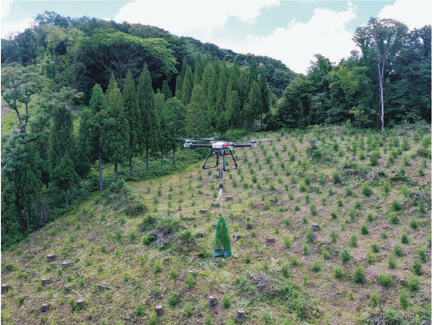
林業用運搬ドローンによる苗木運搬 (氷見市中谷内地内)
